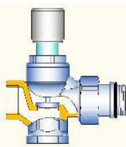
Клапан имеет два входа (прямой и угловой), что дает возможность устанавливать его как на прямых, так и угловых участках трубопровода.
